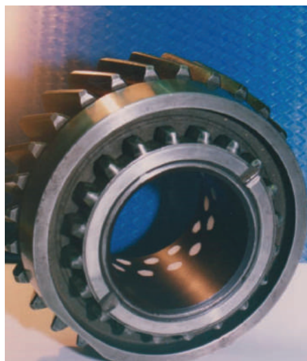
Рисунок 7 – Примеры (автор – Гвоздев А.А.) введения в полимерное антифрикционное покрытие электроотрицательного пластика (вставки или крошка фторопласта) для защиты от водородного изнашивания шеек стальных валов (осей).
