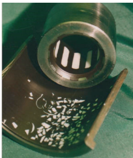
Рисунок 7 – Примеры (автор – Гвоздев А.А.) введения в полимерное антифрикционное покрытие электроотрицательного пластика (вставки или крошка фторопласта) для защиты от водородного изнашивания шеек стальных валов (осей).
