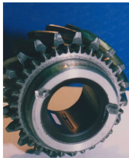
Рисунок 7 – Примеры (автор – Гвоздев А.А.) введения в полимерное антифрикционное покрытие электроотрицательного пластика (вставки или крошка фторопласта) для защиты от водородного изнашивания шеек стальных валов (осей).
